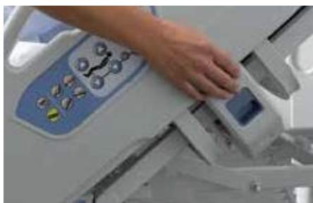
Rilascio della sponda laterale con una mano.
