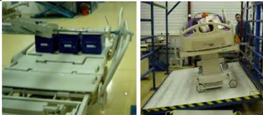
Esempi di test resistenza sponde laterali, stabilità ed efficacia dei freni
